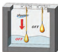
Il livello min. arresta la pompa Low level stops the pump
