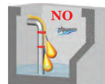
Installazione errata Wrong installation
