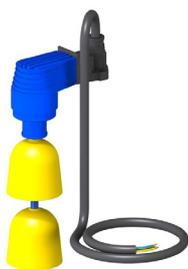
La sua caratteristica costruttiva permette il suo utilizzo su pozzetti molto piccoli usabile anche in presenza di detriti e in acque sporche dove non è possibile usare galleggianti flottanti. Il meccanismo di commutazione è magnetico.
