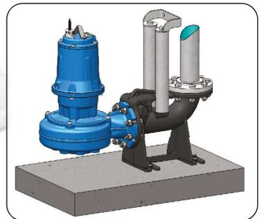
Esta solução instalação fixa é vantajosa, pois permite retirar facilmente e rapidamente e reposicionar posteriormente a electrobomba no tanque durante a manutenção e limpeza da electrobomba sem a necessidade de esvaziar o tanque ou o colector ou mesmo remover qualquer parafusos.
