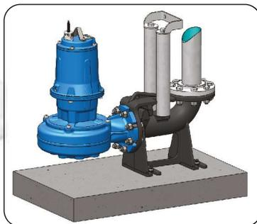
Cette solution s'avère avantageuse en cas d'installation fixe, car elle permet d'effectuer aisément et rapidement le retrait et le repositionnement successif de l'électropompe dans la cuve lors des opérations d'entretien et nettoyage de la pompe sans nécessité de vider la cuve de collecte ni de démonter aucun boulon.
