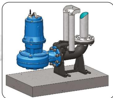
È questa la soluzione più conveniente nel caso di installazioni fisse perché consente di effettuare facilmente e velocemente l'estrazione e il successivo riposizionamento dell'elettropompa nella vasca, permettendo di eseguire la manutenzione e la pulizia della elettropompa senza dover svuotare la vasca di raccolta o smontare alcun bullone.
