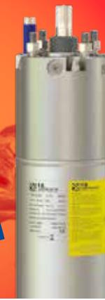
**■ Motor ad Alta Temperatura:** avvolgimento in HT, statori e rotori con maggiore presenza di acciaio e rame, tenuta meccanica in carburo di silicio SIC-SIC/VITON, guarnizioni EPDM, classe di isolamento F, speciale liquido riempimento Ecogel Plus, temperatura stoccaggio -48°C +75°C.
