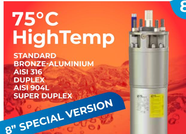
**Motori ad Alta Temperatura:** avvolgimento in HT, statori e rotorì con maggiore presenza di acciaio e rame, tenuta meccanica in carburo di silicio SIC-SIC/VITON, garnizioni EPDM, classe di isolamento F, speciale liquido riempimento Ecogel Plus, temperatura stoccaggio -48°C +75°C.
