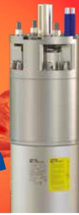
**■ Motor ad Alta Temperatura:** avvolgimento in HT, statori e rotori con maggiore presenza di acciaio e rame, tenuta meccanica in carburo di silicio SIC-SIC/VITON, guarnizioni EPDM, classe di isolamento F, speciale liquido riempimento Ecogel Plus, temperatura stoccaggio -48°C +75°C.
